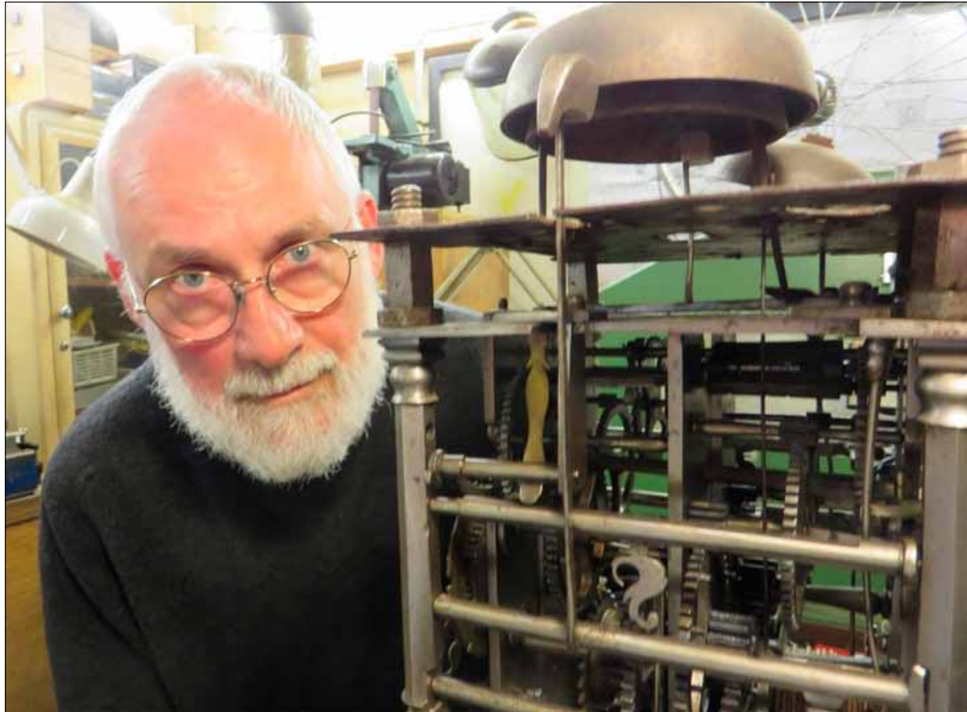
Jochen Motschmann bringt gerade wieder die Uhr zum Laufen, die einst im Magistrateszimmer des Rathauses stand. Der Uhrmacher stellt sie neu ein und ölt das Laufwerk. Fotos: ca
