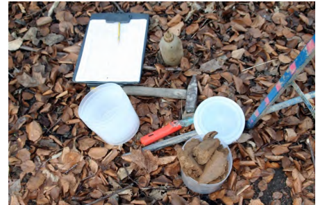
Sondierung von Erdschichten auf dem Gelände der PK Lüneburg: Entnahme einer Bohrsonde zur Begutachtung und Entnahme von Tonproben
