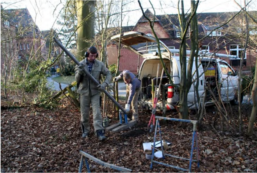
Sondierung von Erdschichten auf dem Gelände der PK Lüneburg: Entnahme einer Bohrsonde zur Begutachtung und Entnahme von Tonproben
